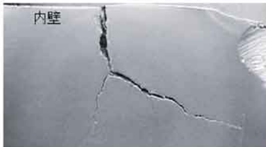
图2 壁厚横截面裂纹宏观形貌
