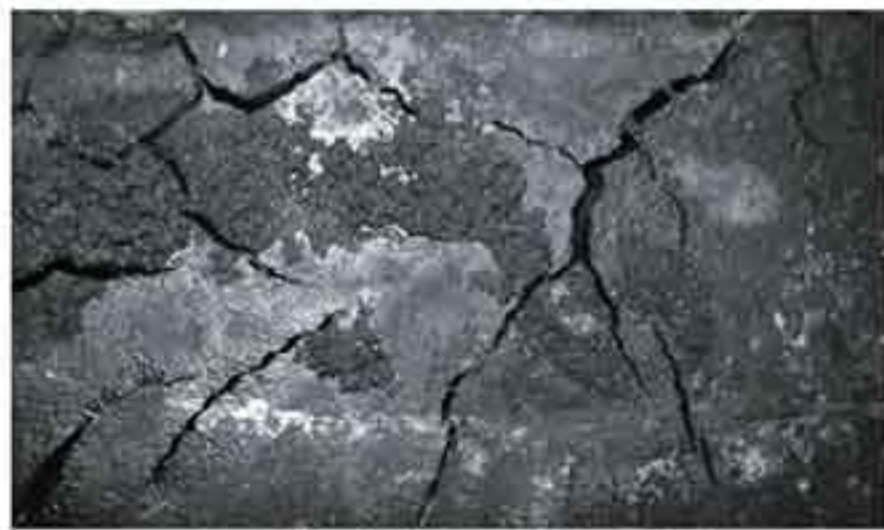
图1 封头内壁断口裂纹宏观形貌
