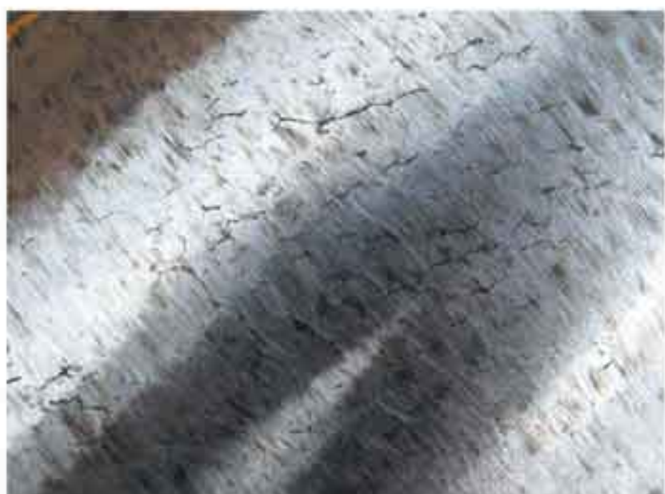
图2 钢管外表面密集的缺陷图
