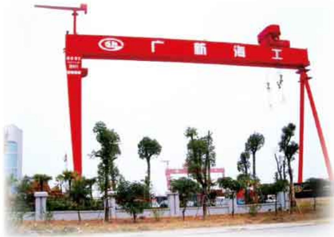
600 吨造船门式起重机检验现场
